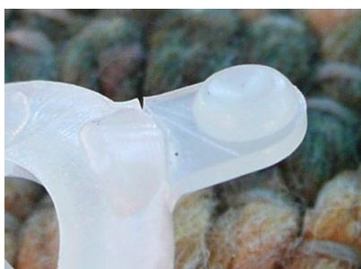
Para solucionarlo basta dar un par de puntos de soldadura (sin estaño, solo tocar con el soldador) en las esquinas de cada extremo fisurado.
