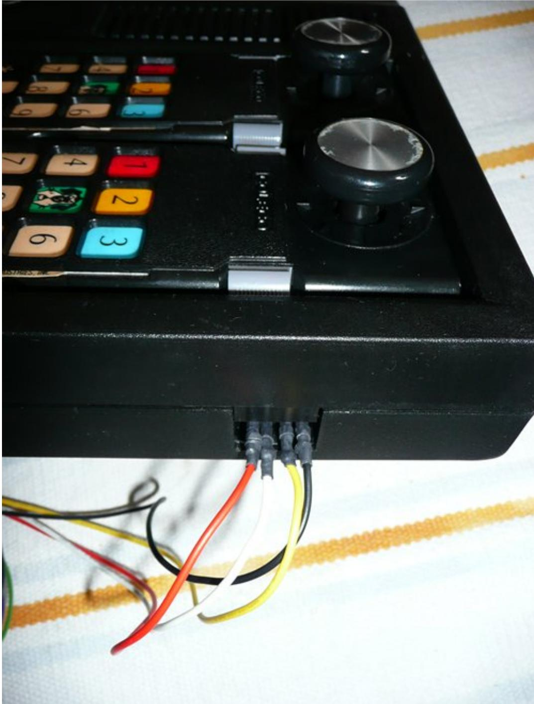
Antes de seguir conviene probar a encender el equipo, un tufillo a quemado nos indicará que algún cable está mal conectado.
