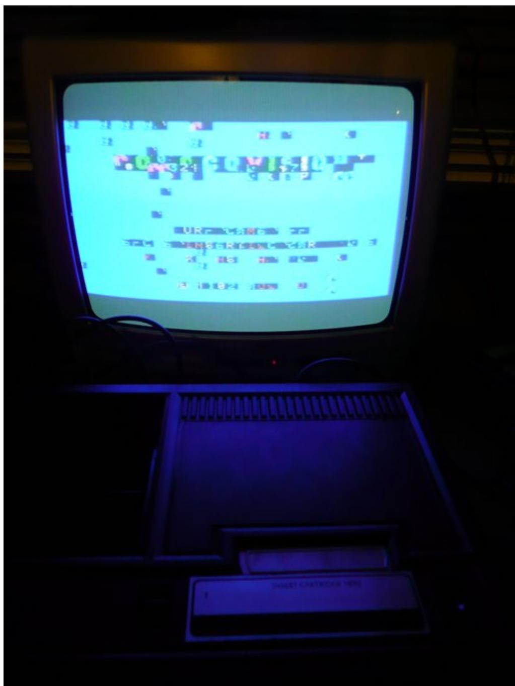
En este caso, la solución pasa por desconectar el cable de conexión de antena interno, limpiar un poco el conector y al volver a conectarlo la señal ha mejorado enormemente.
