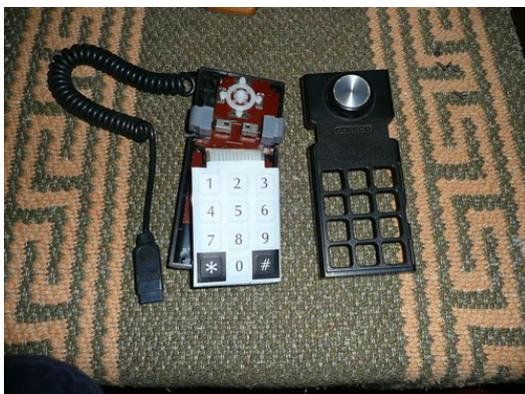
Se puede apreciar que los extremos correspondientes a las direcciones que no funcionaban tiene una fisura. Por esto, al mover el joystick en una direcci3n, la cruceta no siempre ejerce la presi3n suficiente en el interruptor, resultando el juego inmanejable.
