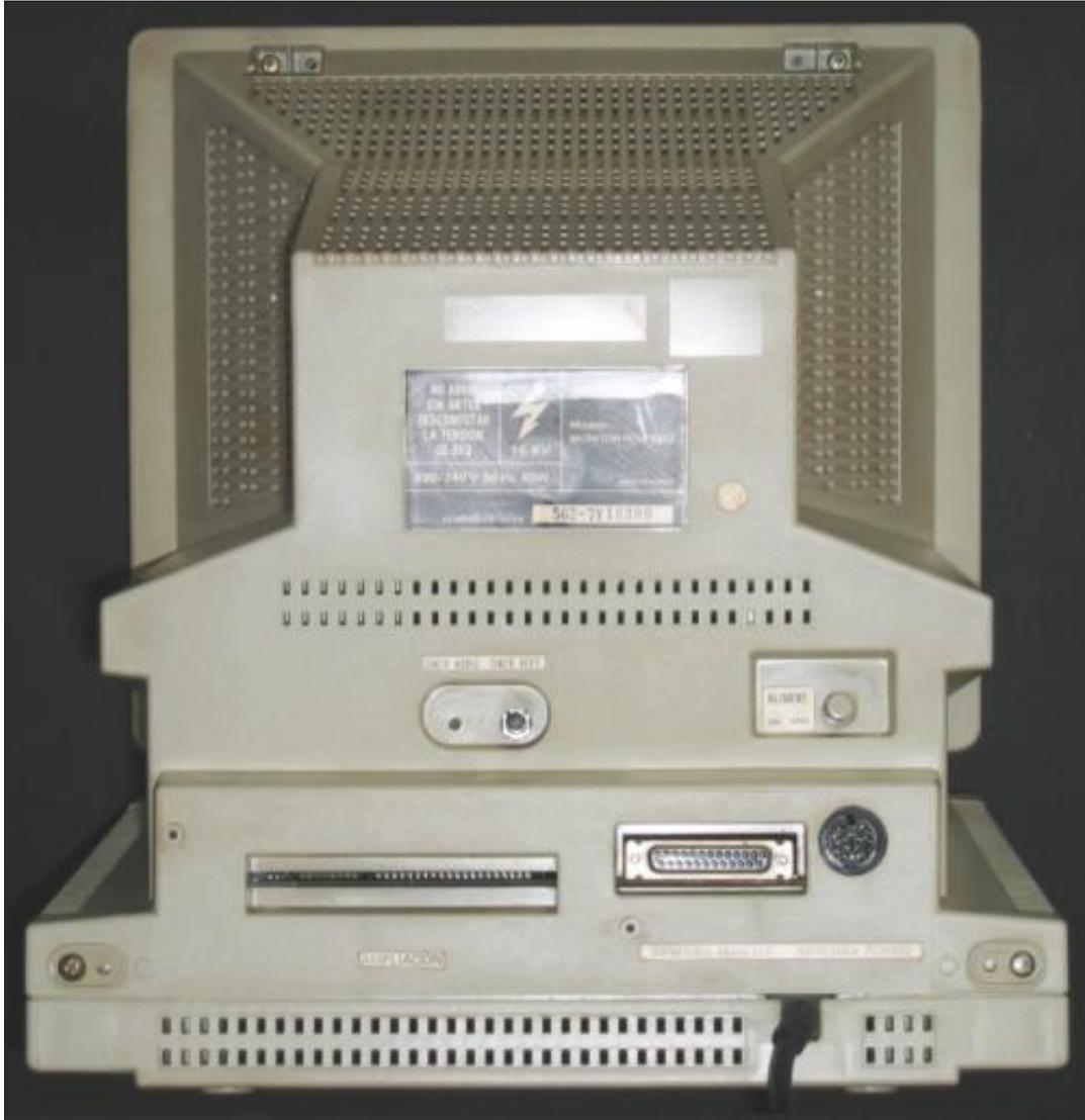
*En la parte trasera se encuentran, ademÃ¡s de los conectores ya mencionados, el botÃ³n de encendido y los ajustes de sincronismo vertical y horizontal*
