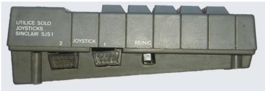
*En un lateral se encuentran el botón de reset y dos puertos de joystick (norma Atari, protocolo Sinclair)*
